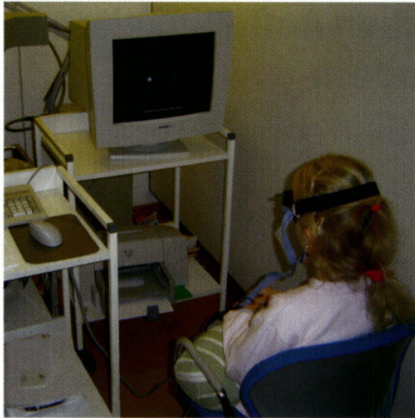
Abb. 3 ▲ a, b Blickmotorikmessung mit Infrarotreflexionsokulographie
